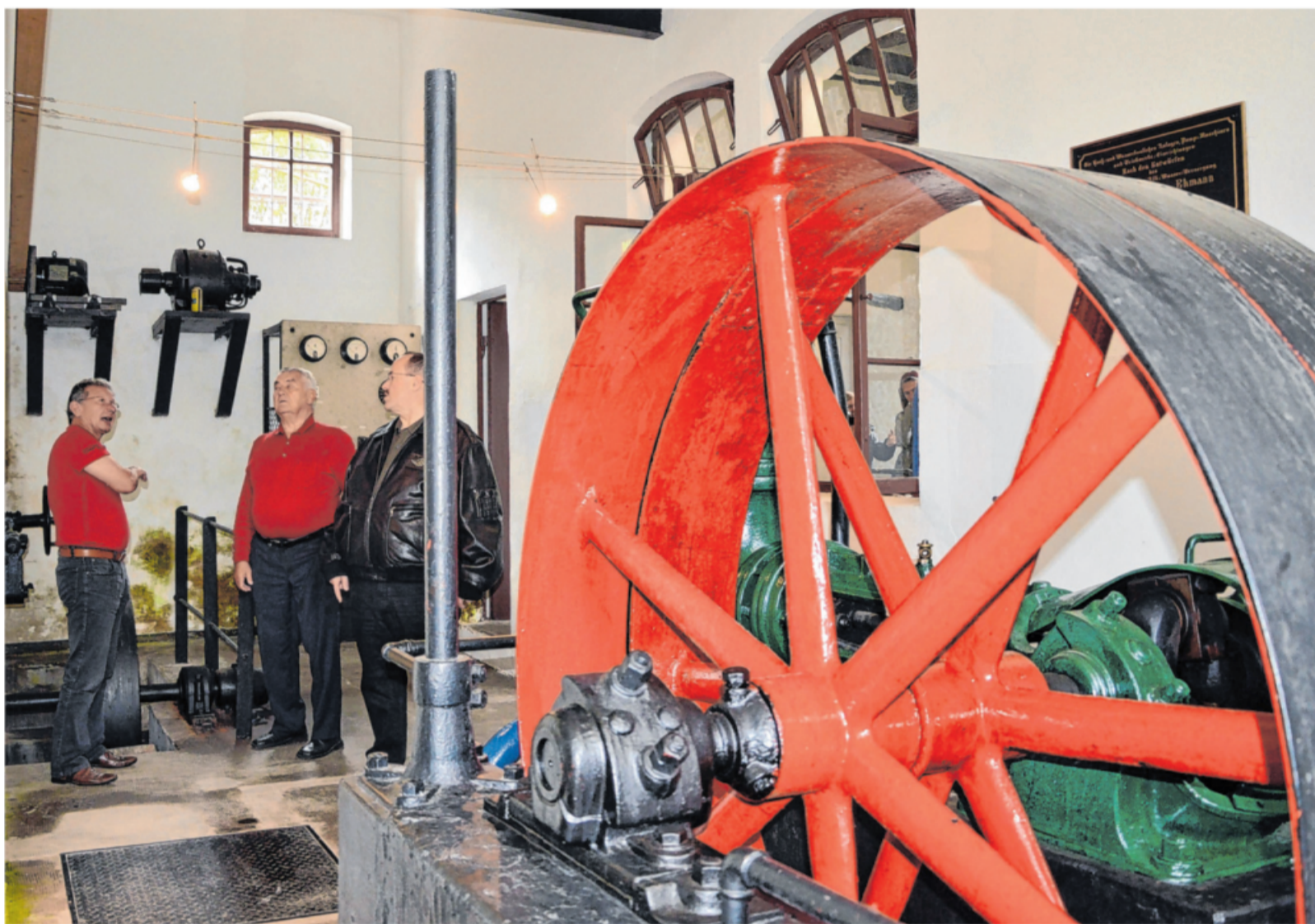
Die von der Kraft der Schmiech angetriebene Pumpe in Teuringshofen drückte Wasser hoch nach Hausen, Justingen und Ingstetten. Sie ist ein Symbol der Pionierleistung von damals. Foto: Inge Burkhardt
